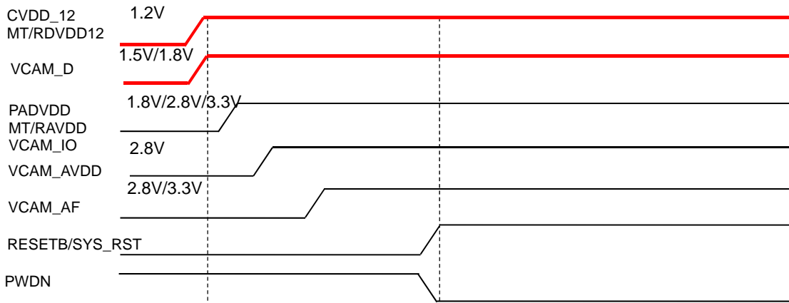
图 10 XC6131 与 sensor 上电顺序
